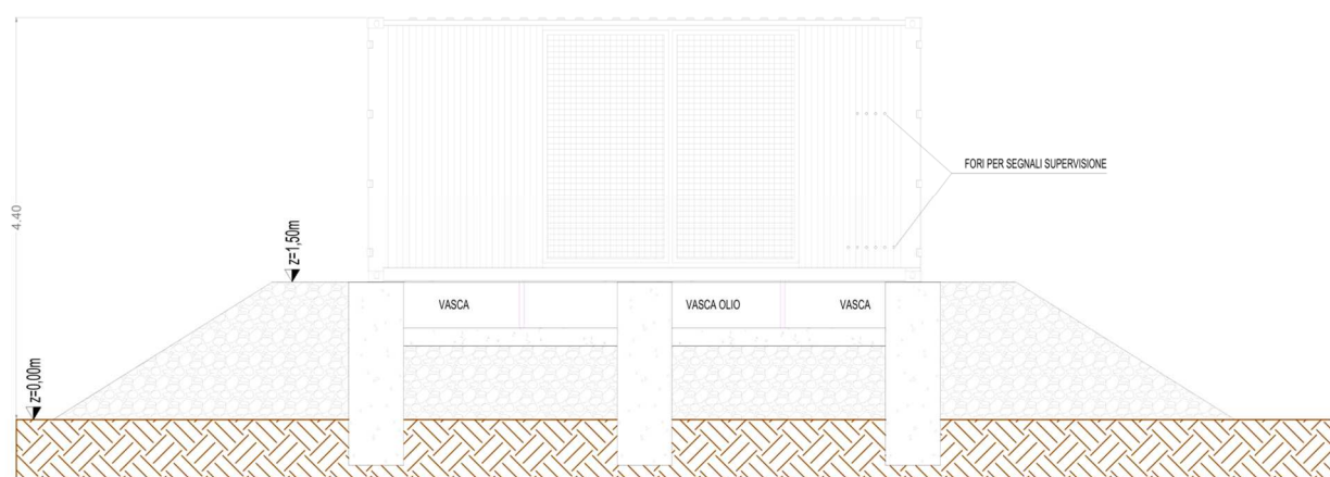
Figura 7-1. Schema di posizionamento dei cabinati elettrici.
